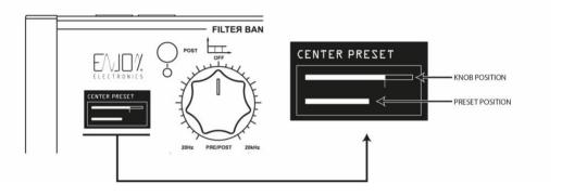
Il parametro (e quindi l'Effetto) non cambia fino a quando la posizione della manopola (barra superiore) non supera il valore corrente del parametro (barra inferiore).
